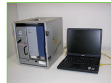
Tragbarer µGC zur Messung von Gasodor™ S-Free™, Acrylaten und Gaszusammensetzung
