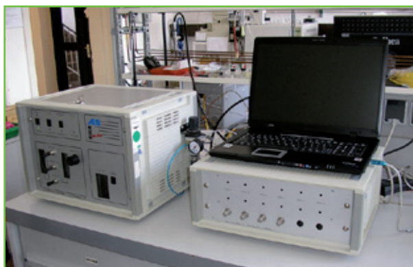
Odor-Online, Gaschromatograph zur Bestimmung der Konzentration schwefelhaltiger Odoriermittel
