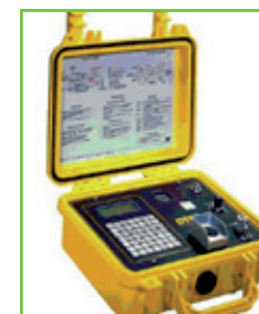
DTEX-Gerät zur Ermittlung der Geruchsintensität
