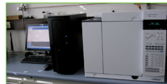
Stationärer Gaschromatograph: Bestimmung u. a. von Gaszusammensetzung und -begleitstoffen
