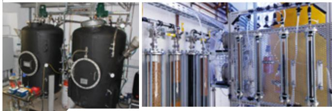
Abb. 1: 2 m<sup>3</sup> Versuchfermenter und Biogasaufbereitung
