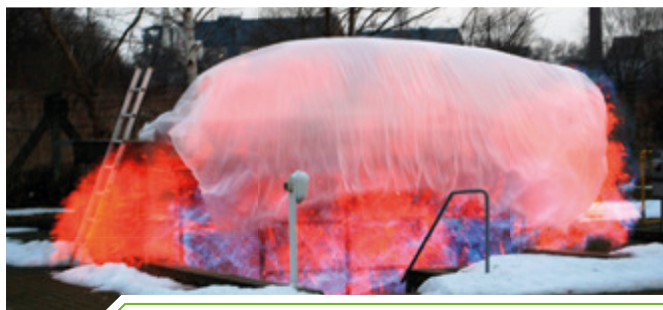
Gasexplosion im geschlossenem Kellerraum auf der BSDA
