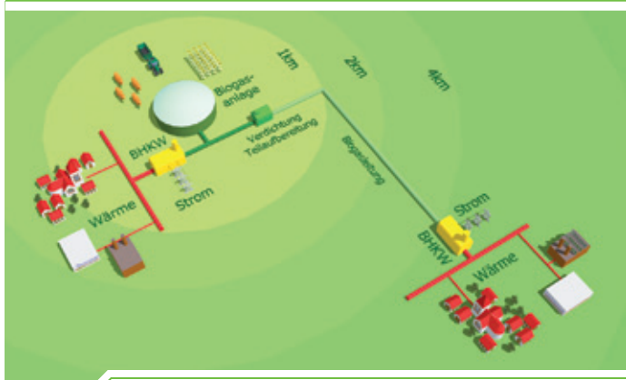
Mögliche Biogasnutzungspfade (z.B. dezentrale Nahwärme-/Biogasnetze)
