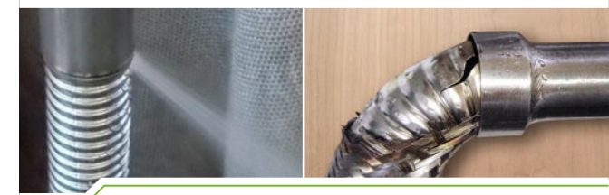
Undichtheit nach Druckstoßtest, Zerstörter Schlauch nach Berstversuch (v.l.n.r.)
