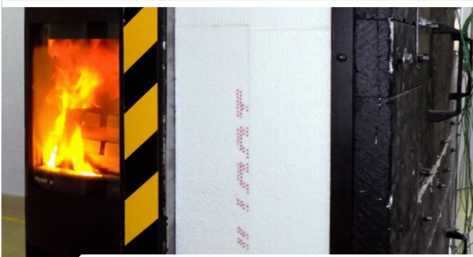
Brandsicherheitsprüfung an einem Raumheizer im Prüfeck mit hochwärmegeprägter Wand
