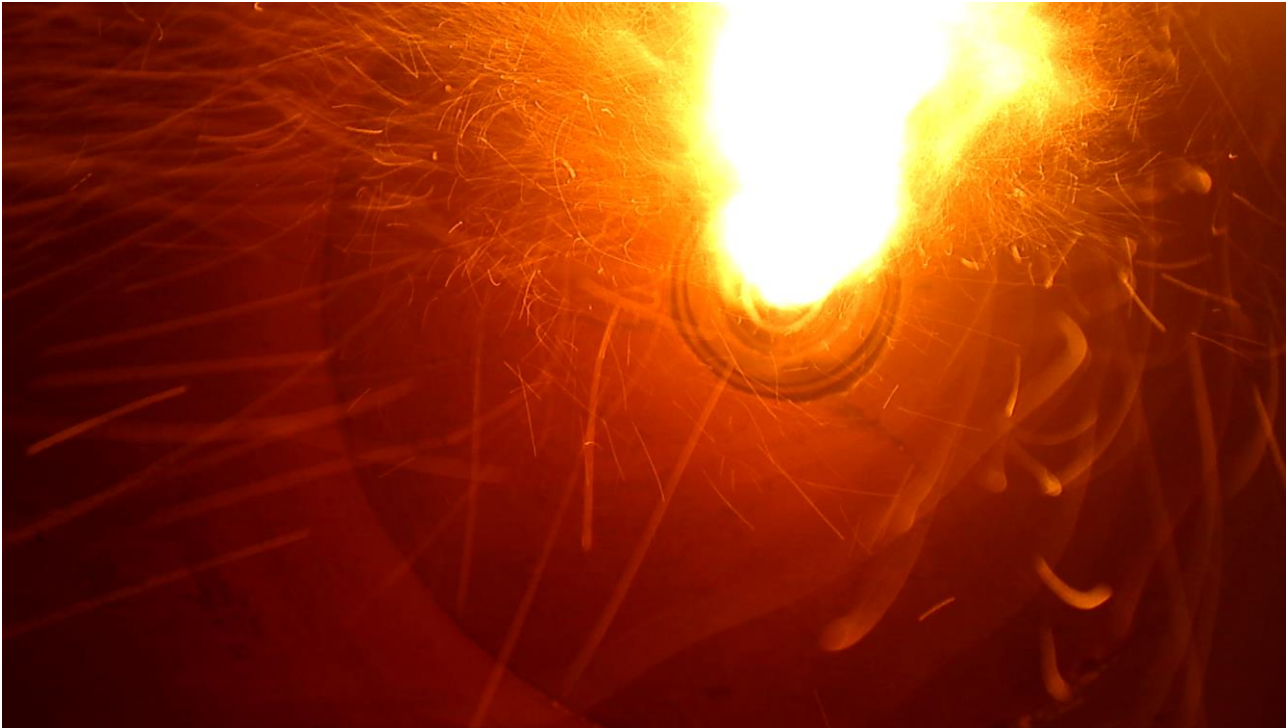
Abbildung 1: Flamme eines braunkohlegefeuerten Kessels
