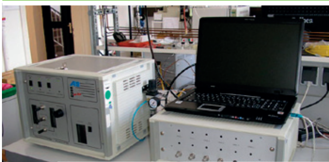
Odor-Online, Gaschromatograph zur Bestimmung der Konzentration schwefelhaltiger Odoriermittel
