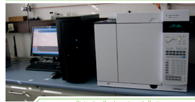
Stationärer Gaschromatograph: Bestimmung u. a. von Gaszusammensetzung und -begleitstoffen
