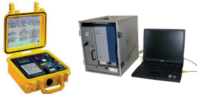
DTEX-Gerät zur Ermittlung der Geruchsintensität (I.) & Tragbarer µGC zur Messung von Gasodor® S-Free, Acrylaten und Gaszusammensetzung
